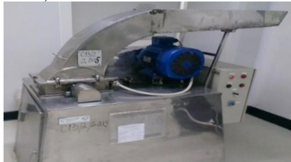
Fig.4 Moara pentru mărunțit planta „modelul MMC 002– Remeco”
