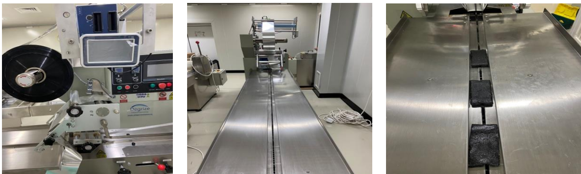
Fig.9 MAȘINA AMBALAT ȘI IMPRINTĂ CU RIBON – LINX TT500 –DEGRIZE Modelul: TT500
